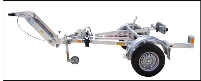
Dieser Einachsanhänger kann mit einer Zugöse für **PKW** oder alternativ mit einer Zugöse für **LKW** ausgerüstet werden.
