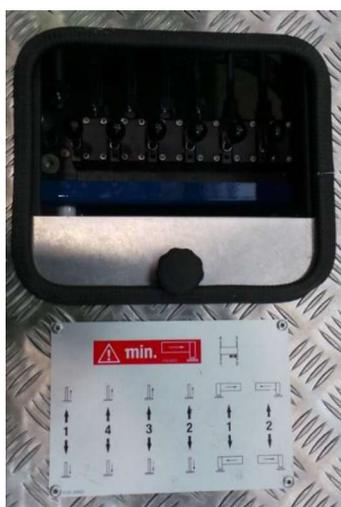
Abb. 8-18 Stützensteuerblock Fahrerseite
