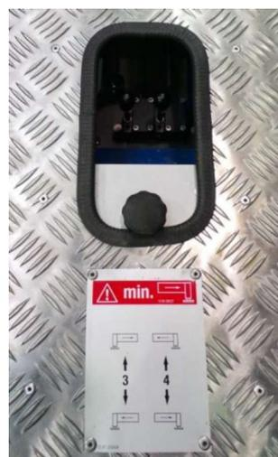
Abb. 5-4 Stützensteuerblock (Beifahrerseite)
