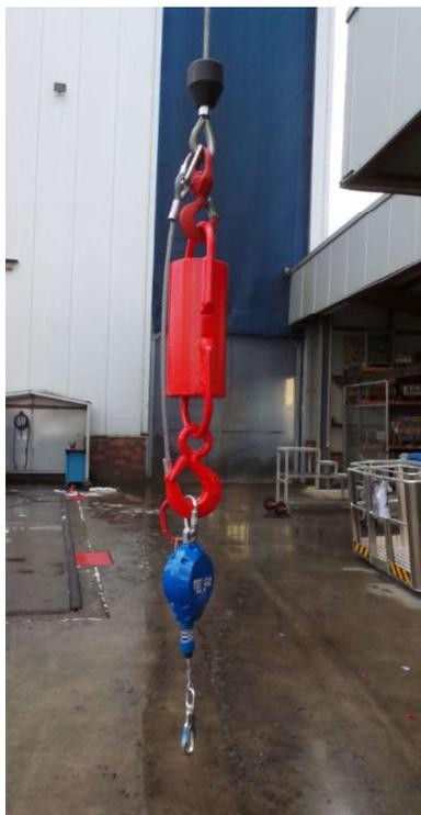
Abb. 10-12 Redundante Sicherung am Kranhaken
