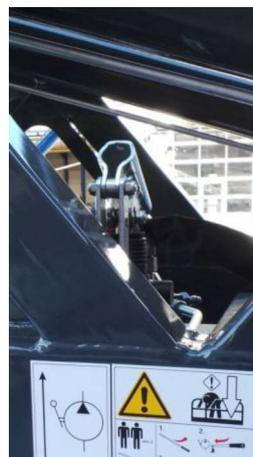
Abb. 5-8 Einrichtung für Notpumpe
