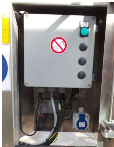
Abb. 5-13 Steuerschrank in der Arbeitsbühne
