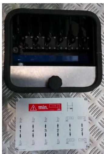
Abb. 5-5 Stützensteuerblock (Fahrerseite)
